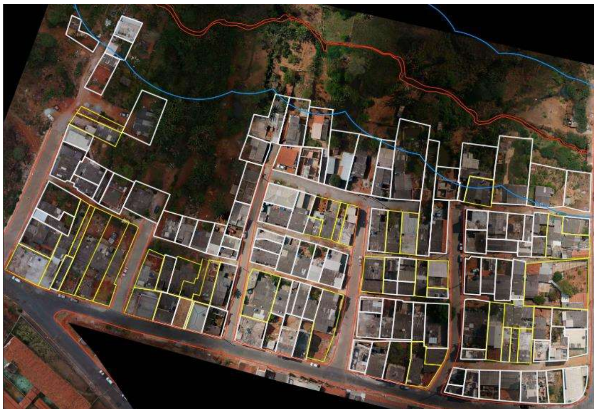
Figura 6 - Sobreposição do levantamento topográfico aprovado.
